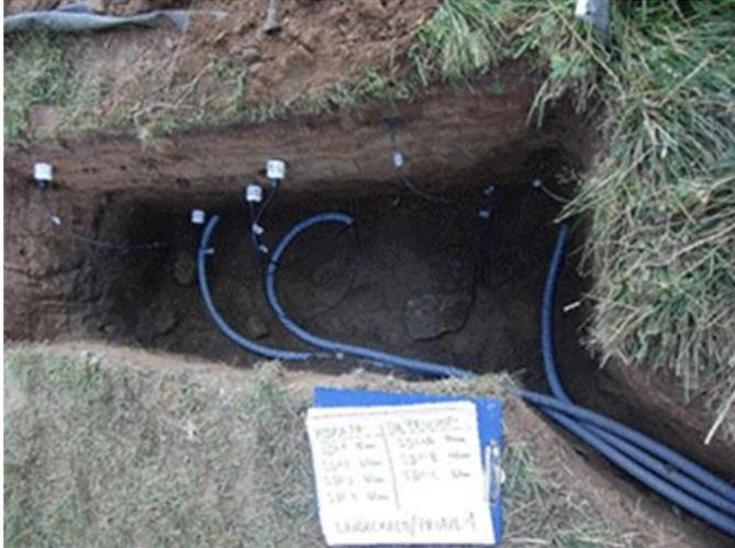
Abbildung 5.8: Führung der Sondenkabel in Schutzschläuchen vom Datenlogger ins Bodenprofil.
