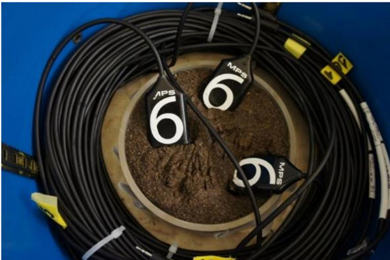
Abbildung 4.3: Einbau von Matrixpotenzialsensoren (Decagon MPS-6) in der Druckplattenapparatur zur Kalibrierung
