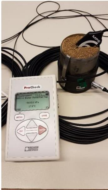
4.4: Versuchsanordnung zur Validierung der Messwerte von Decagon Matrixpotenzialsensoren (MPS-6) mittels HYPROP-System
