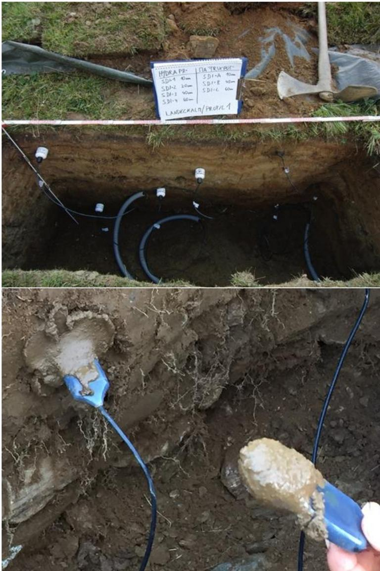
Abbildung 5.10: Anordnung der FDR-HydraProbe Sonden (linke Bildhälfte) und der MPS-6-Sensoren (rechte Bildhälfte) – Standort Landeggalm.
