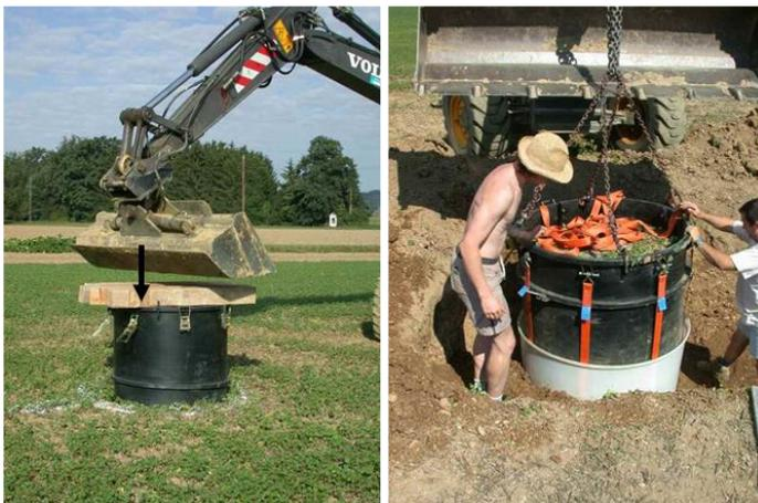
Abbildung 11.16: Ausstechen und Einbau des monolithischen Lysimeter
